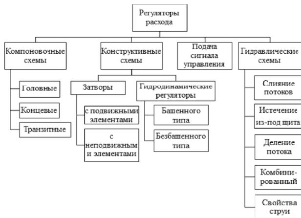
Рис. 3. Классификация регуляторов расхода Д.М. Бенина
