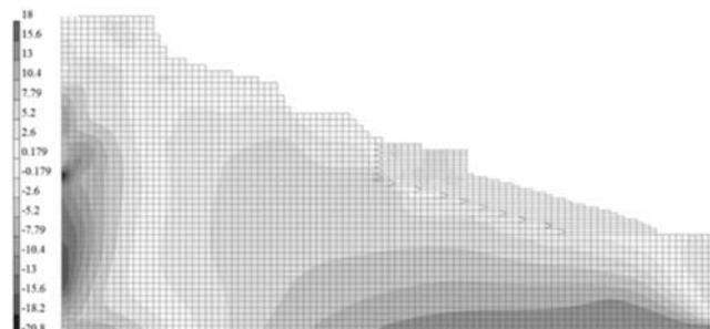
Рисунок 5. Касательные напряжения, т/м<sup>2</sup>
