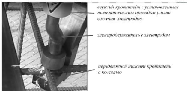
Рис. 2. Крестообразное соединение, выполненное контактной сваркой
