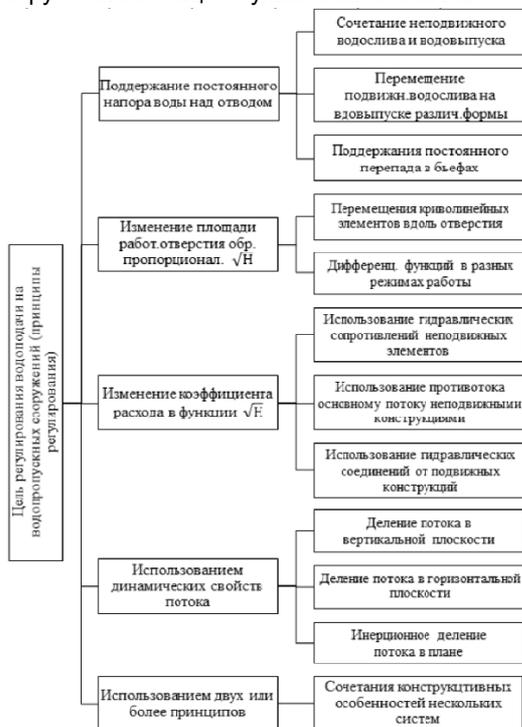
Рис. 2. Классификация водовыпусков-стабилизаторов по Атамановой О.В.
