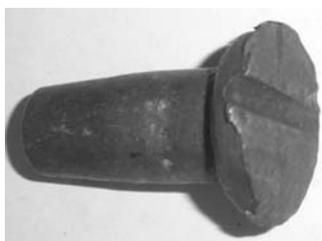
Рисунок 8. Определение износа рабочей поверхности электрода при осуществлении процесса контактной сварки
