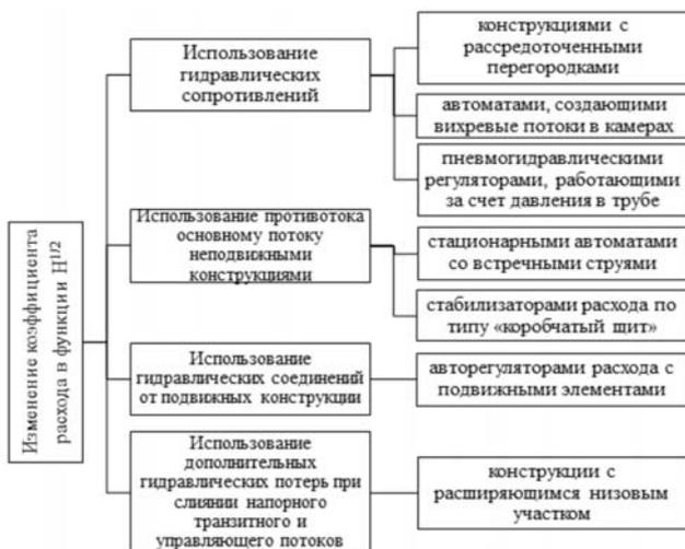
Рис. 4. Классификация автоматических водовыпусков А.А. Гайсина
